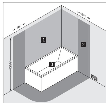
\* nebo výška nejvyšší napevno umístěné sprchové hlavice / výpusti vody; podle toho, co je výš
