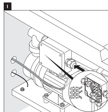
**II** Podłączyć przewód wyrównania potencjałów do wanny z hydromasażem.
