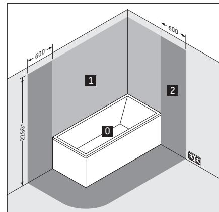
\* vai visaugstāk uzstādītā dušas sietiņa / ūdens izplūdes augstums; atkarībā no tā, kas atrodas augstāk
