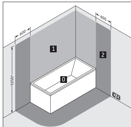
\* 或固定安装的淋浴喷头/出水口的最大高度; 以最大高度为准
